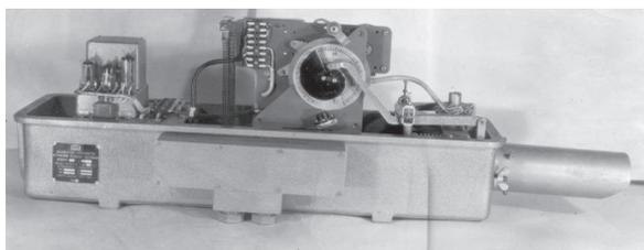
Рис. 3. Плотномер ИПВФ
